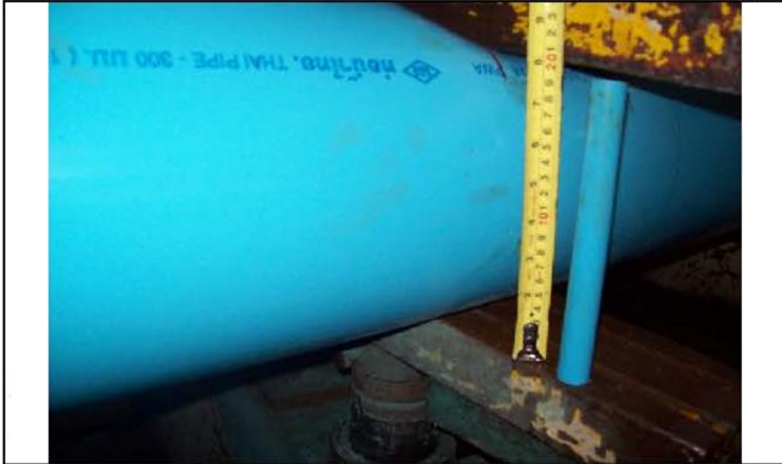
ชุบตัว 40 % ระยะระหว่างแผ่นขนานที่ลดลงบนหลังท่อ 190.8 มม.
