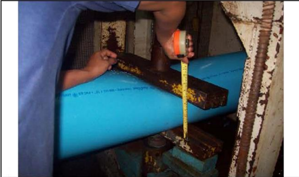
ชุบตี้ว 50 % ระยะระหว่างแผ่นขนานที่ตกลงบนหลังท่อ 159 มม.
