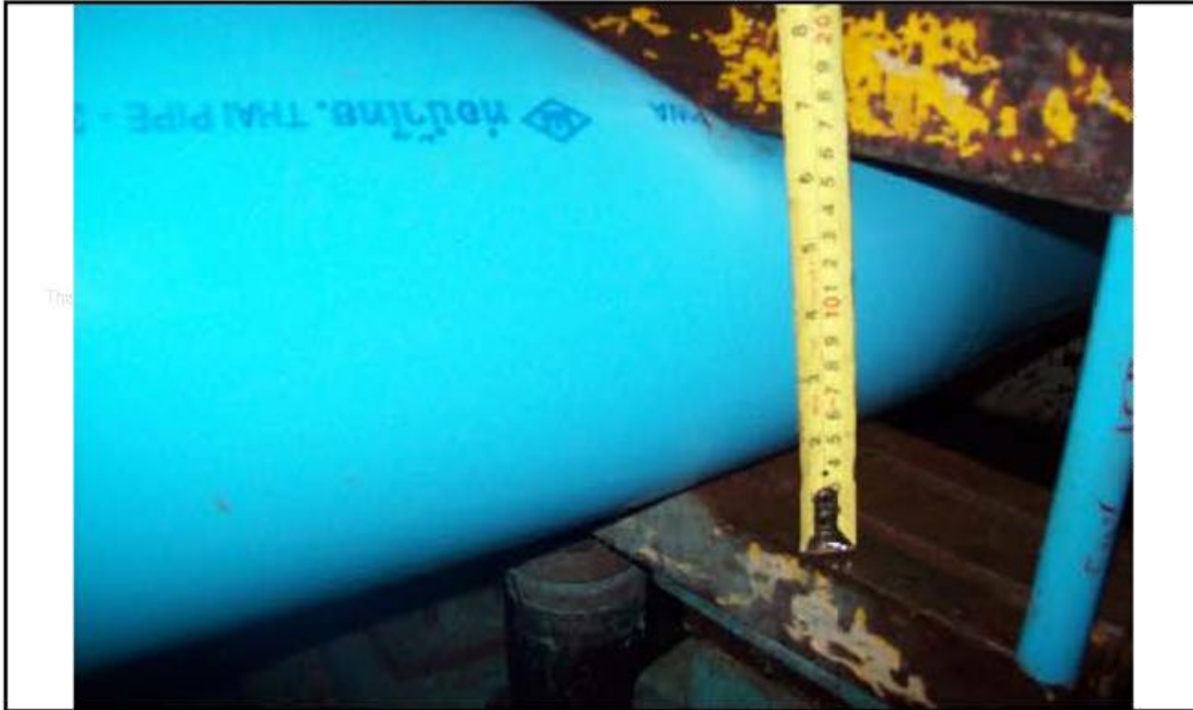
ซบตัว 50 % ระยะระหว่างแผ่นขนานที่กดลงบนหลังท่อ 159 มม.
