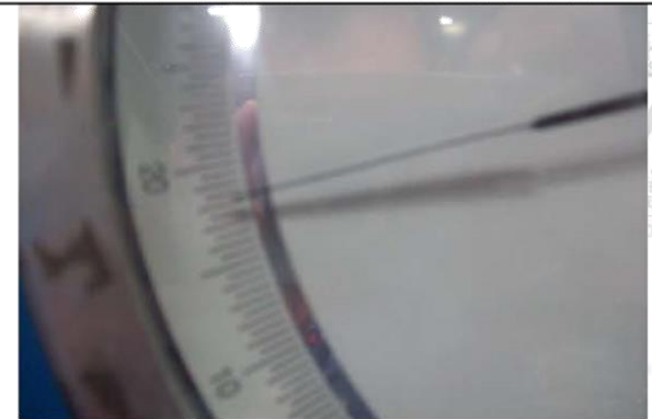
แรงดันชั้นที่ 18 บาร์ ทดสอบแรงดัน 18 บาร์/30 นาที
